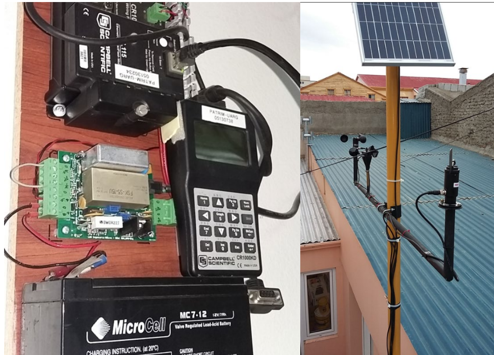
Figura 8: (izq) Alimentación de un CR1000+Display con módulo UPS+PWRSv1, conectado a red y a panel solar, y (der) vista del panel de 20 W y conjunto de sensores de viento.
